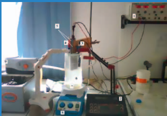
Procédé électrochimique : Electrocoagulation (réacteur Batch) dépollution des eaux
