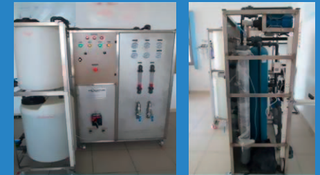
Procédé membranaire osmose inverse: Unité pilote de dessalement des eaux
